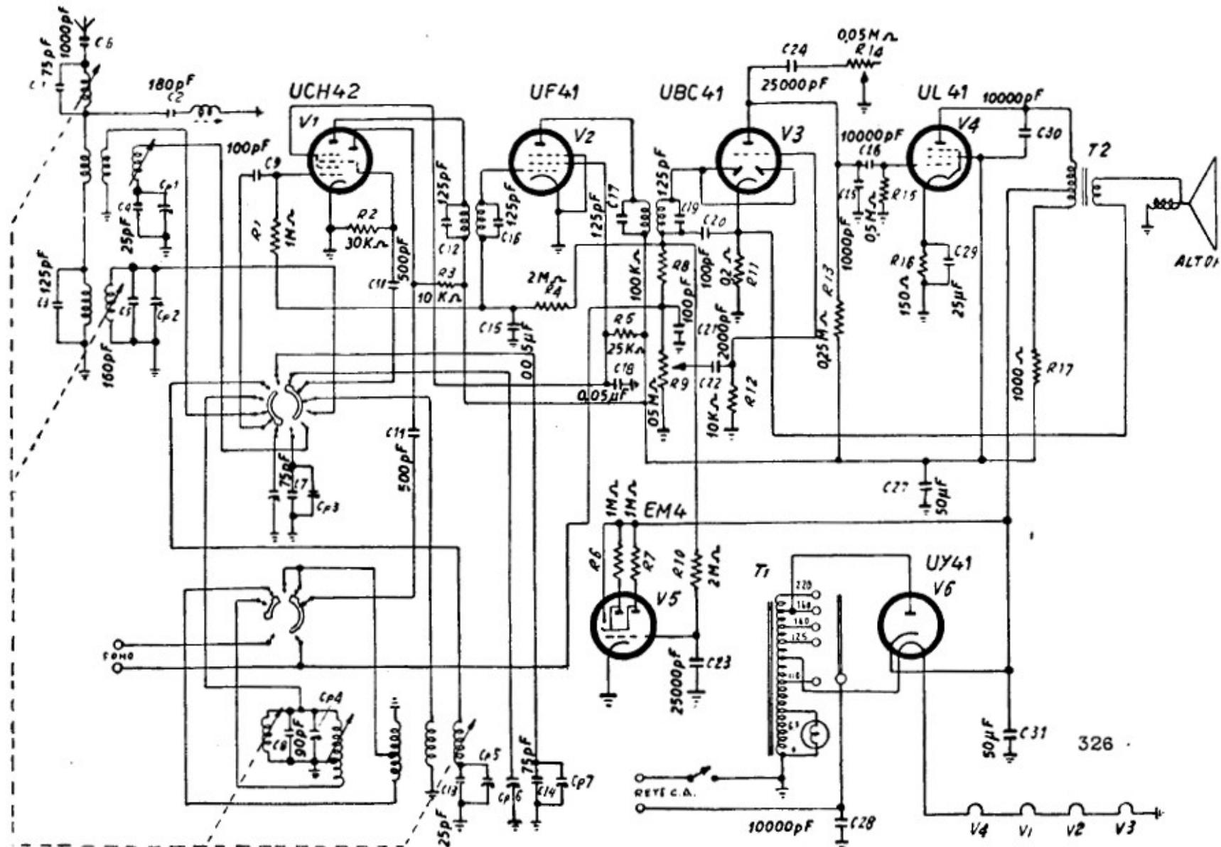
ALLOCCIO BACCHINI - Mod. 326. Ricevitore a 6 valvole, provvisto di controreazione fissa in BF. Media frequenza 465 kc.
